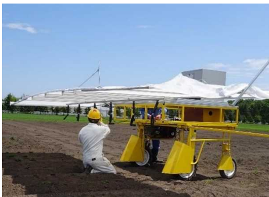
自動検出プログラムを搭載したほ場管理車両
