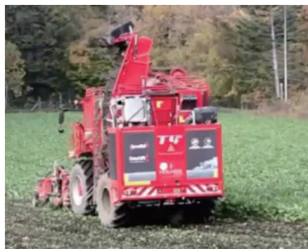
図1 本プロジェクトで導入した海外製ビートハーベスタ（大型収穫機、移植栽培に対応した改造ヘッドを装着している）
