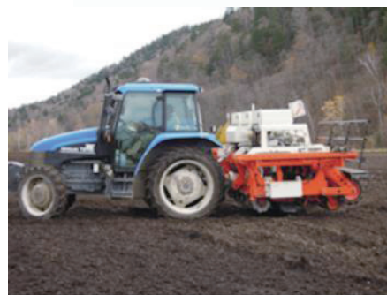
図2 本プロジェクトで開発したテンサイ移植機（サークル機工が開発、狭畦・6畦に対応、苗取りをロボットが行う全自動タイプ）
