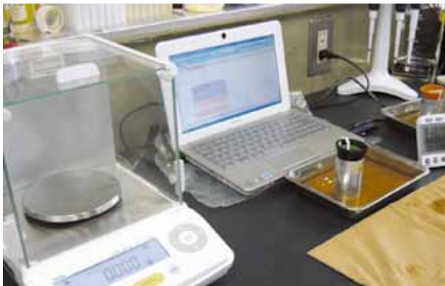
図 2 吸水性評価装置の全貌
