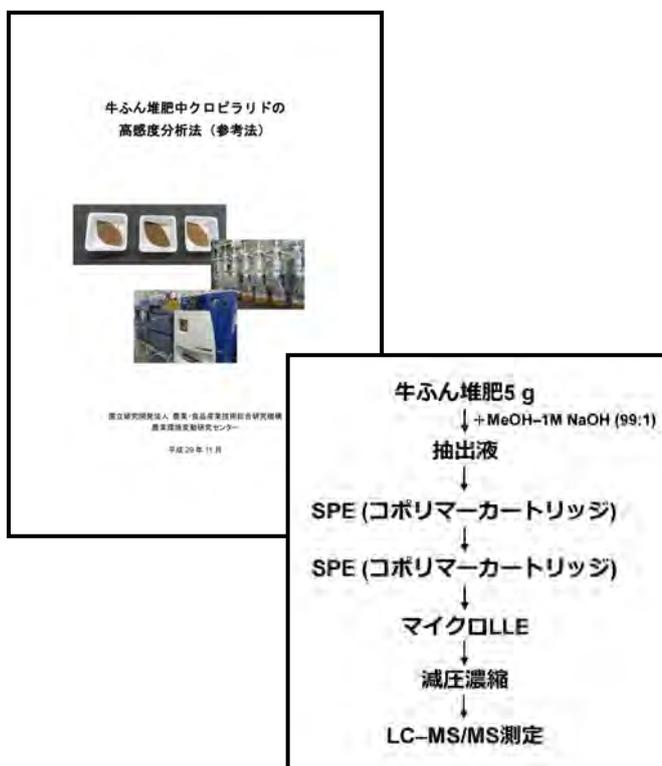
本分析法は牛ふん堆肥中のクロピラリドをアルカリ性下でメタノール抽出し、酸性とアルカリ性でクロピラリドの溶出挙動が変化することを利用して、親水性及び親油性の官能基を併せ持つ固相を充填したカートリッジ及び液液溶媒抽出によりクリーンアップした後、高速液体クロマトグラフタンデム質量分析計を用いて測定する方法です。
