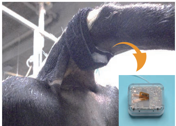
牛の尾に装着した体温センサ(右下)
