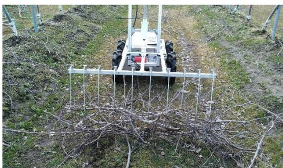
図3 枝回収レーキモジュール使用時
