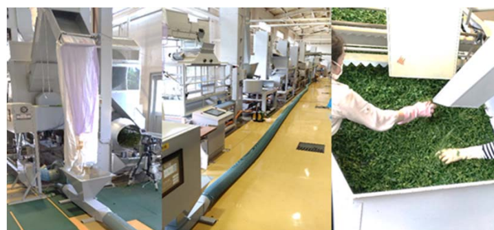
図54 送風ダクトによる茶葉の運搬
