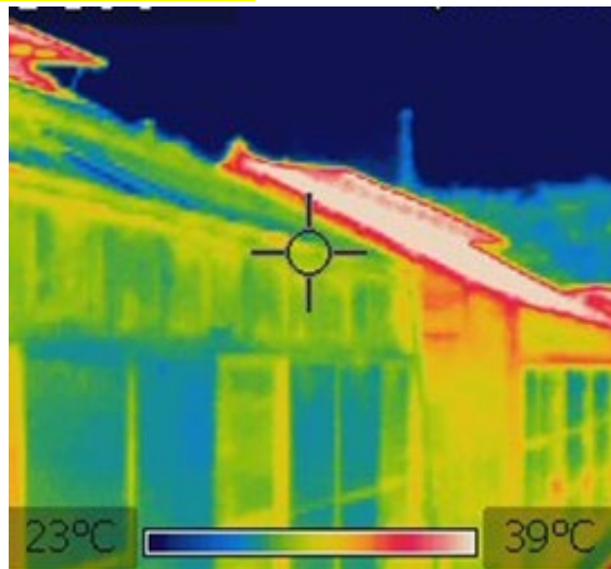
図 屋根散水の実施状況とサーモグラフィによる温度変化（手前：屋根散水ハウス、奥：対照）
