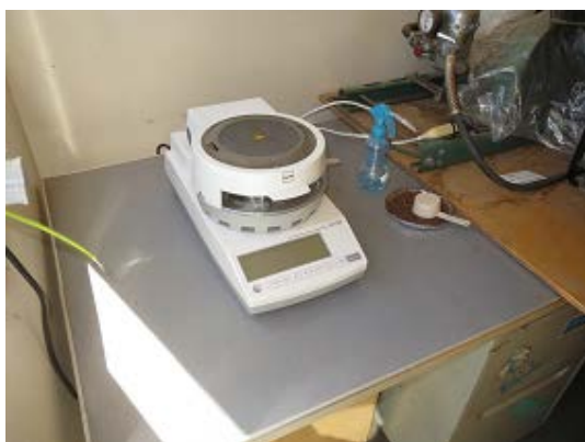
写真10 堆肥生産現場で簡易測定可能な赤外線水分計
