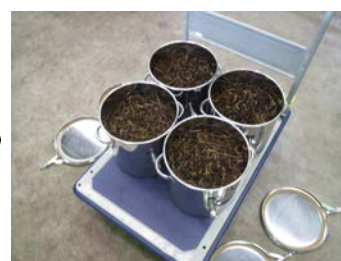
かさ密度0.3~0.4 kg/Lを目安に反応槽（11 L）へ充填
