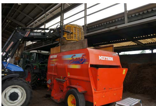
写真9 けん引式のカッティングミキサーの外観(左)と混合・細断時の内部の様子(右) ロールベールに巻かれた麻ひもは細断されて、オーガへの絡みつきは確認されなかった
