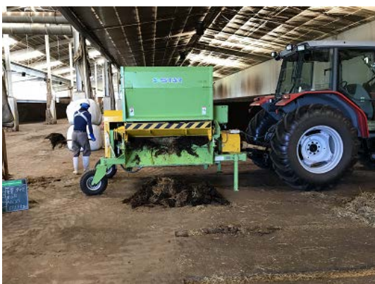
写真7 第2章の堆肥化試験に供したベールカッター（STAR FRBC-120）
