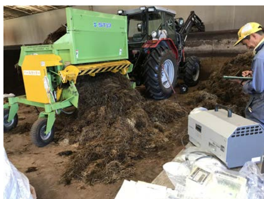
写真12 汚染牧草の細断作業中の粉じんと空間線量率の測定
