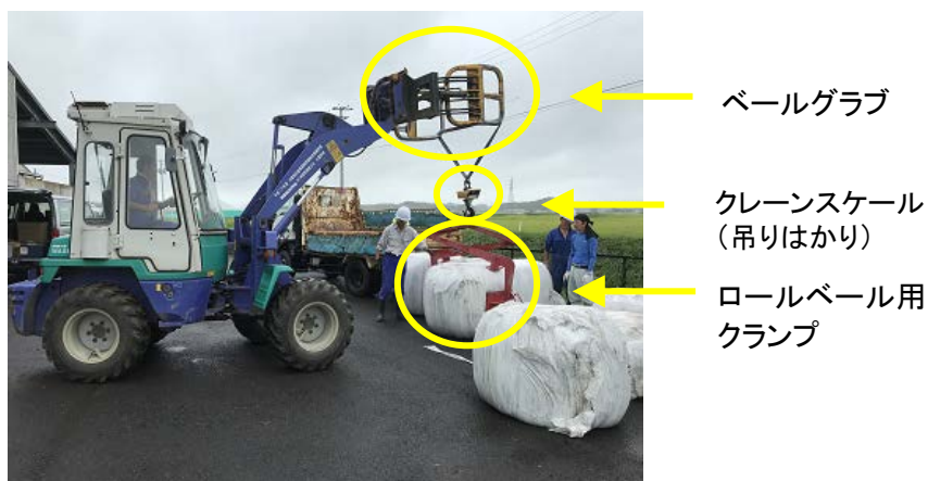
写真6 ホイルローダーのアタッチメントとして多用されるベールグラブとフォークリフト作業にも対応可能なロールベール用クランプ
