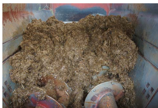
写真9 けん引式のカッティングミキサーの外観(左)と混合・細断時の内部の様子(右) ロールベールに巻かれた麻ひもは細断されて、オーガへの絡みつきは確認されなかった
