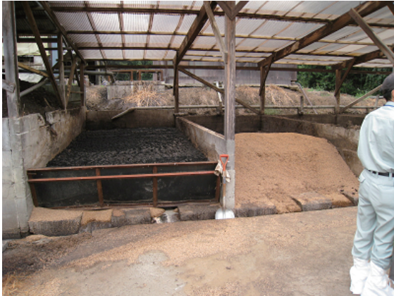
写真 5 モミガラによる脱水処理と水分調整
