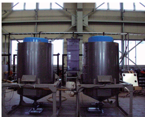
写真 2 堆肥原料は送風機で通気される
