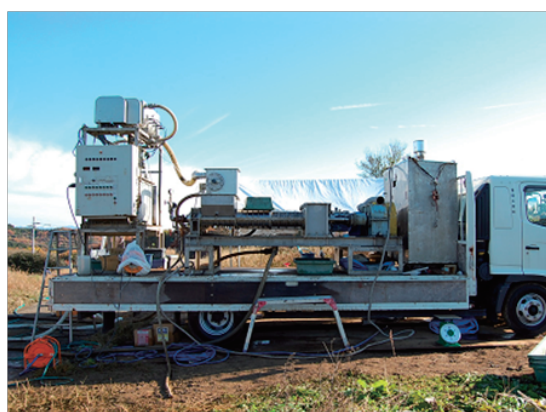
写真3 供試した可搬式の固液分離機
