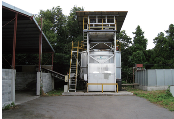
写真 10 HL 牧場の密閉縦型堆肥化装置
