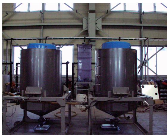
写真 2 堆肥原料は送風機で通気される
