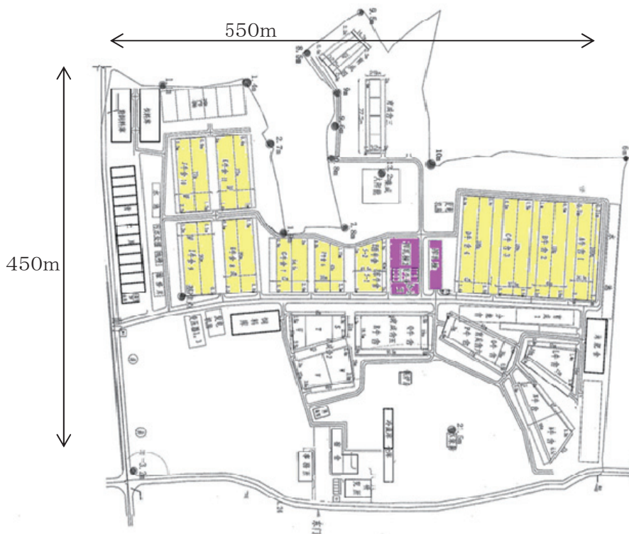
図 20 B 牧場の施設レイアウト(黄色部分が搾乳牛舎、赤色部分がミルクングパーラ)
