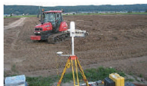
高精度GPSを活用した省力・精緻なほ場管理技術 (均平作業は、従来より約4割省力)
