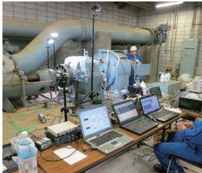
■ 実機ポンプの促進劣化試験
