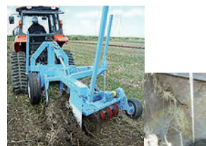
新たな有材心土破砕機「カットソイル」 (地表面にある作物残渣などを利用して、地中に排水溝を形成)
