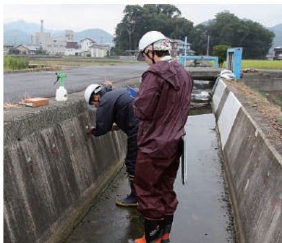
■ 補修材料の長期耐久性現地調査
