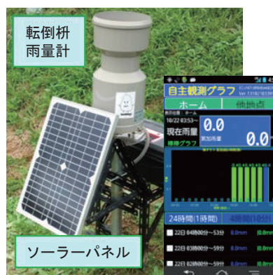
■ 開発した雨量観測・閲覧システム
