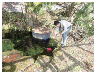
■ 環境同位体観測のための湧水池での採水
