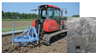
新たな無材心土破砕機「カットドレイン」 (深い施工と排水空洞の持続性が特徴)
