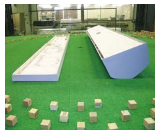
風洞にセッティング中の温室模型
