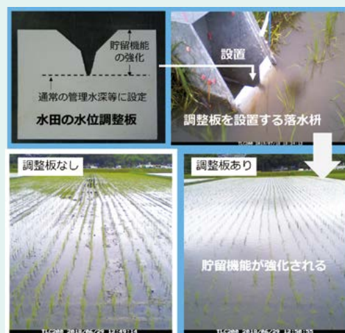
図2 水位調整器の設置による豪雨時の水田雨水貯留の様子
