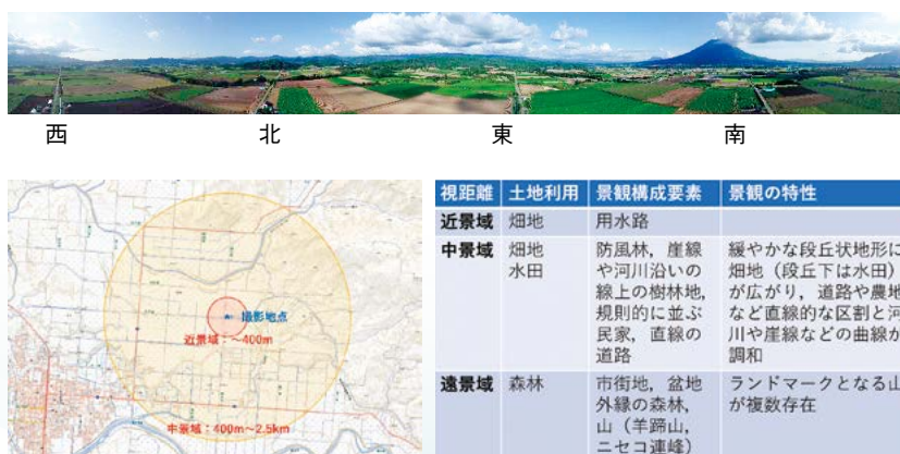
図2 小型 UAV による 360° 全方位撮影の例(上が撮影画像、左下が撮影地点と視距離)と撮影画像から把握できた景観特性(右下)
