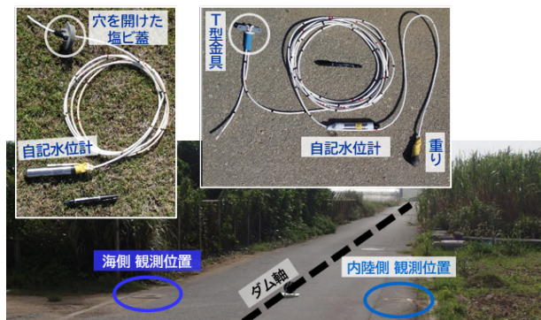
▲図2 観測機器の設置方法と観測配置の例
