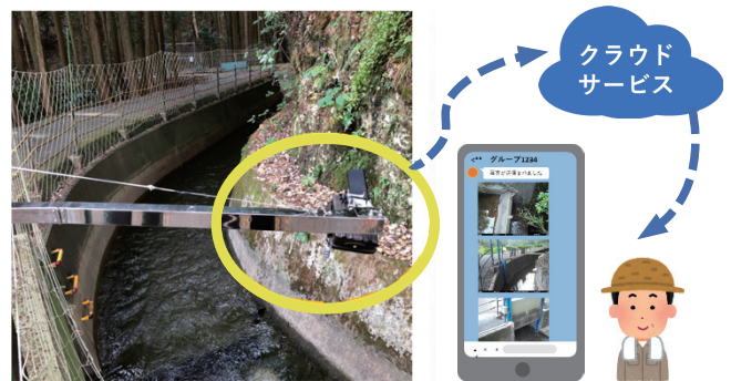
▲図1 トレイルカメラ設置例（左）グループチャット転送イメージ（右）
