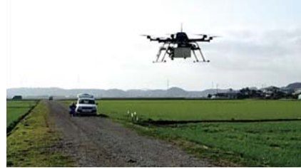
ドローンに搭載された多波長センサの観測データを使って生育診断を行います。
