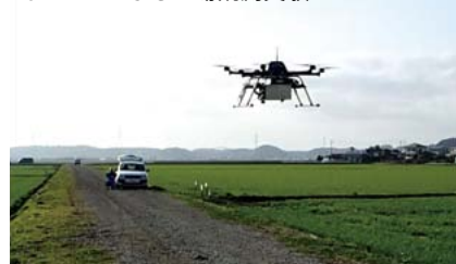
ドローンに搭載された多波長センサの観測データを使って生育診断を行います。
