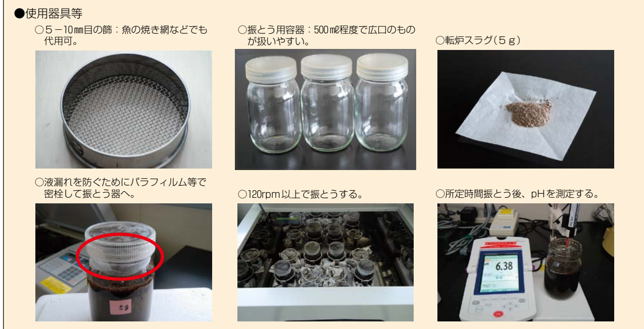
図59 土壌緩衝能曲線作成による転炉スラグ処理量の決定手順
