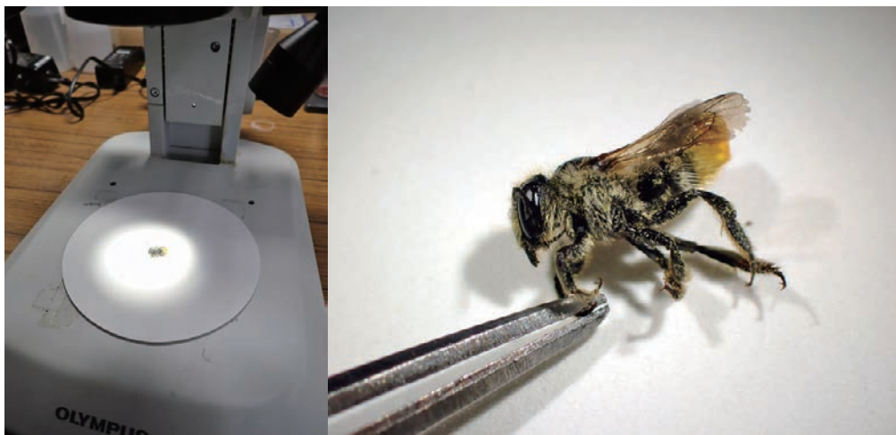
捕まえた昆虫を紙の上に置いて観察する（ピンセットなどで標本を任意の位置・角度に向けることはできるが、固定されないので手ブレなどで観察しにくい）
