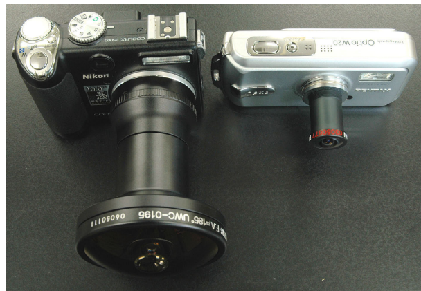
左：ニコン製 COOLPIX P5000（現行品は P5100）＋フィット製魚眼コンバージョンレンズ UWC-0195、価格は 10 数万円程度。 右：ペンタックス製 OptioW20（現行品は W30）＋フィット製 UWC-1628（魚露目 8 号）、価格は 4 万円程度。
