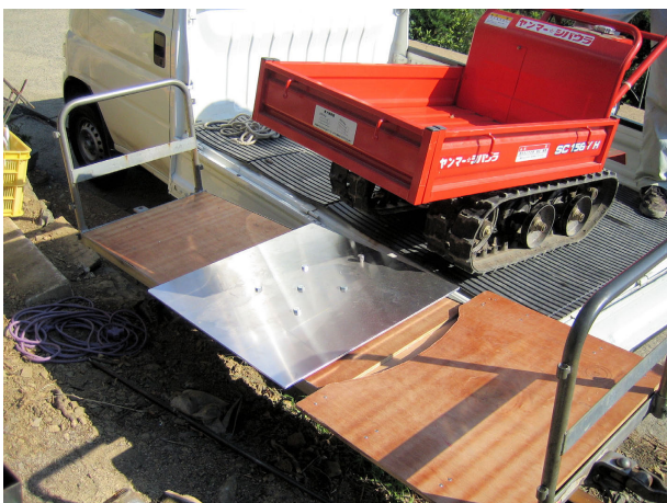
図 8 ターンテーブルを設置した モノレール台車
