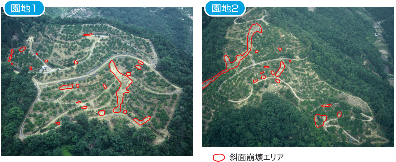
図 6 評価対象園地の斜面崩壊状況
