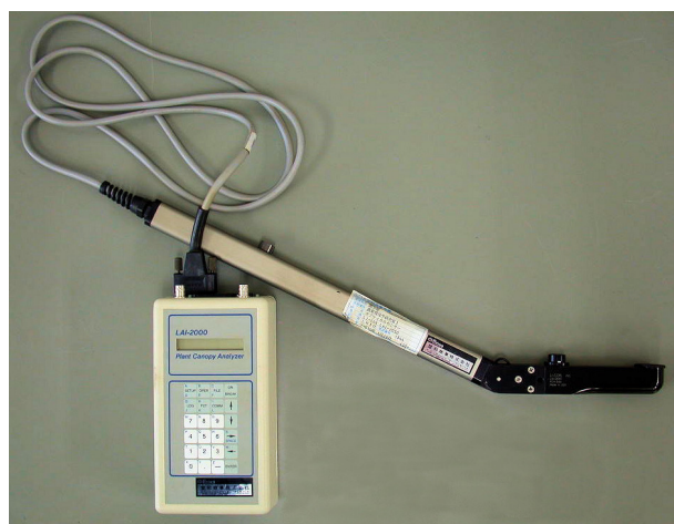
魚眼レンズを内蔵したセンサーとデータロガーからなる。
