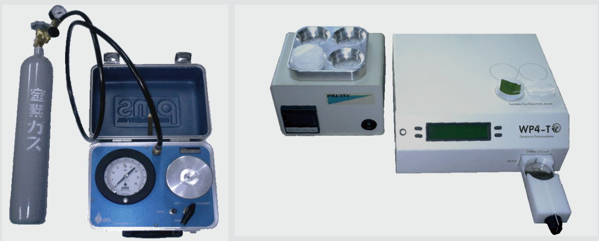
水分ストレスの測定機器(左:プレッシャーチャンバー、右:サイクロメータ)
