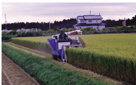
図1 自脱コンバインによる8条分の刈り落とし
