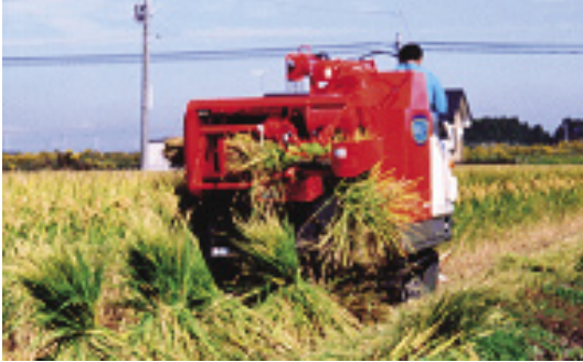
図5 自脱コンバインによる 収穫と稲わらの垂直放出
