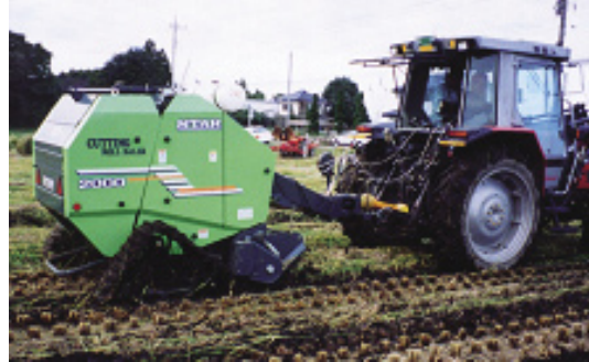
図6 クローラ型走行部を持つ ロールベアラ
