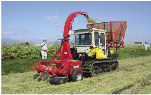
図12 リバース走行クローラトラクタによる FHピックアップ収穫作業
