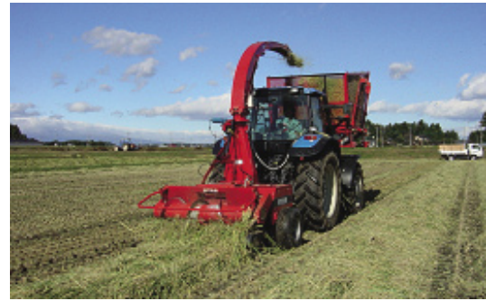
図10 フォレージハーベスタによるピックアップ作業
