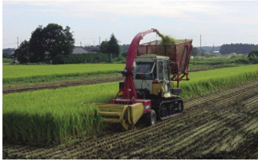
図1 リバース走行クローラトラクタによる FH ダイレクト収穫作業
