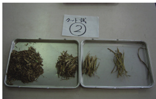
図14 フォレージハーベスタによる収穫システムの細断状態
