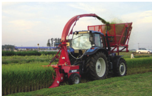
図8 トウモロコシヘッドを用いた飼料イネの収穫
