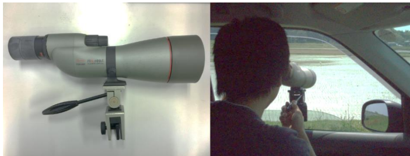
図7. (左) フィールドスコープにカーマウントを取りつけたところ (右) 自動車の窓枠に固定する。双眼鏡よりも遠くまで観察できる
