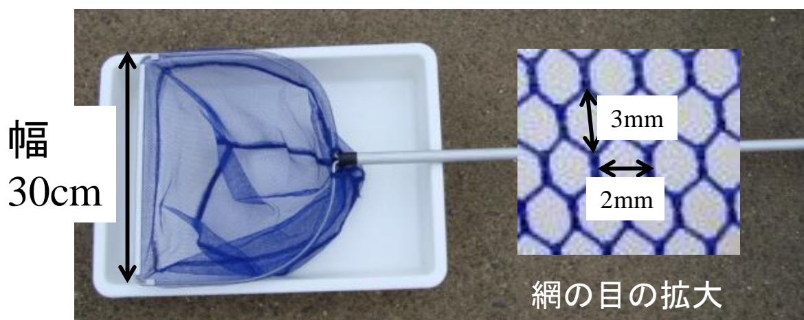
図29. 水中すくい取りに用いるたも網（D型フレーム網）と白色トレー
