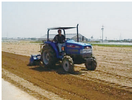
ロータリーによる覆土
