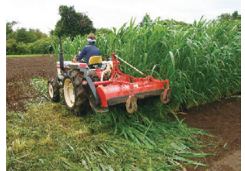
写真 4-7 フレールモアによる細断 「つちたろう (ジャンボ) (雪印種苗)」
