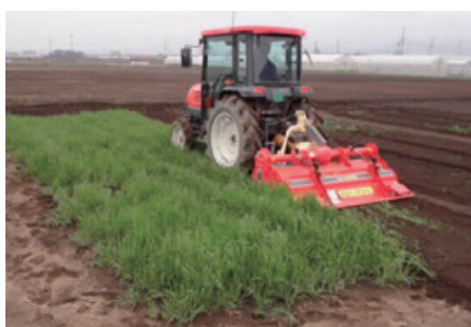
写真 6-8 すき込みの様子 ロータリー (20 馬力) 「緑肥用ライムギ(雪印種苗)」
