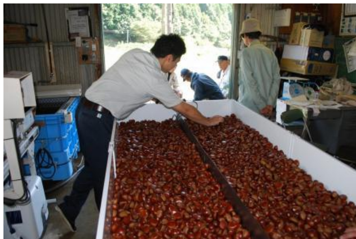
図 2-7. 試作の乾燥機による温湯処理後の風乾作業 装置の下から風が出る構造になっており、100 kg のクリを 乾燥中。
