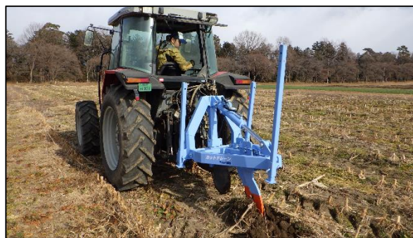
写真 2-1-3 穿孔暗渠成形機の構造 (左) とトウモロコシ畑での作業風景 (右)
