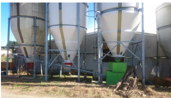
飼料タンク下に設置された粉碎機
