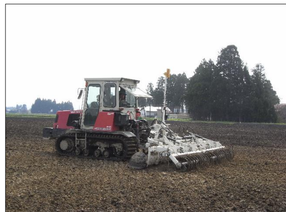
写真 2-1-4 レーザーレベラーと作業風景 (左: 発光機 右: 受光機付き作業機)
