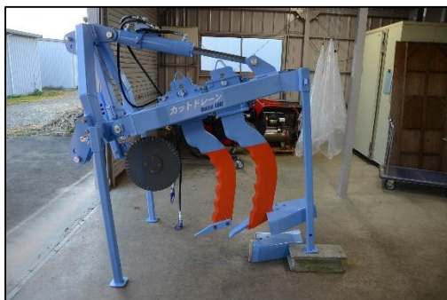
写真 2-1-3 穿孔暗渠成形機の構造 (左) とトウモロコシ畑での作業風景 (右)
