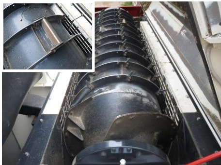
写真 2-4-5 スクリータイプのこぎ胴 左上写真はスクリーロータに装着されている 拡散板
