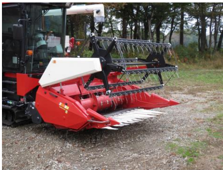
写真 2-4-3 子実用トウモロコシ収穫用のリールヘッド
