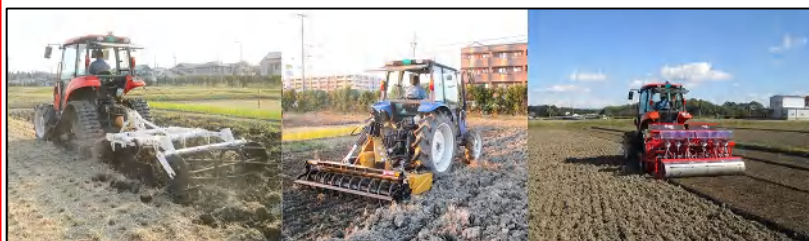
チゼルプラウでの深耕（10月上中旬） 縦軸駆動ハローでの砕土（10月下旬） 小明渠浅耕播種機での畦立播種（11月上中旬）
