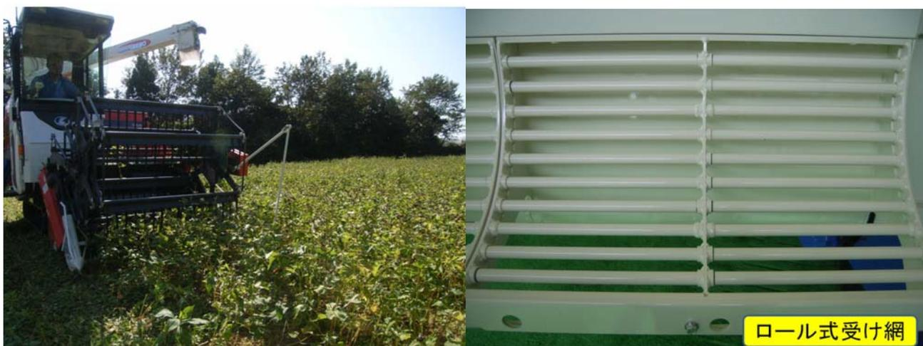
コンバインの脱穀部分の受け網は茎葉が詰まりやすく、選別精度が低下しやすい。受け網部分はロール式かソバ用格子式が詰まりにくい。
