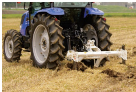
サブソイラによる耕盤破碎
