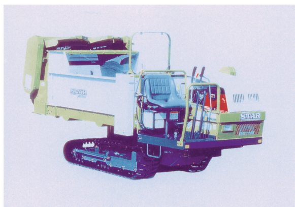
図 4 乗用型自走積み込みマニュアルスプレッド (スター農機)
