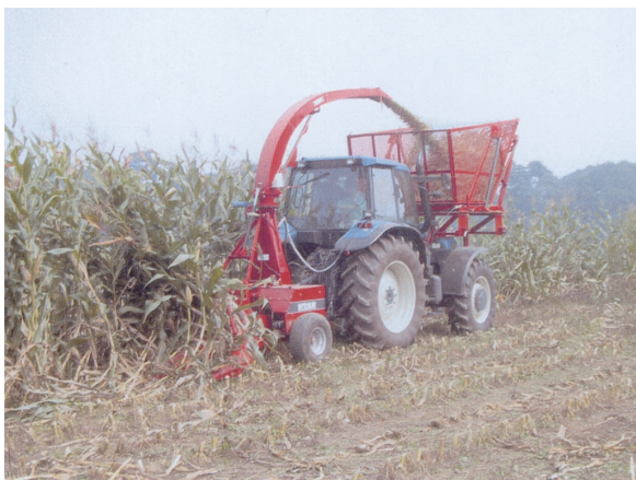
図 3 リバース走行トラクタと直装型フォレージハーベスタによる作業
