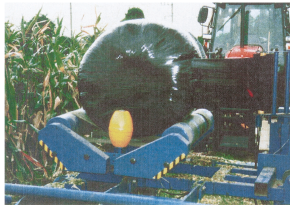
図 5 ベールラッパによる密封作業
