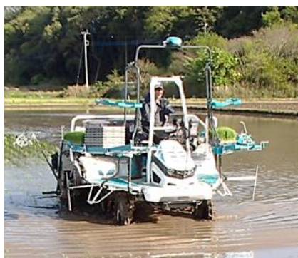
図3-3 湛水状態(水深約5cm)における移植作業と田植機の走行ライン
