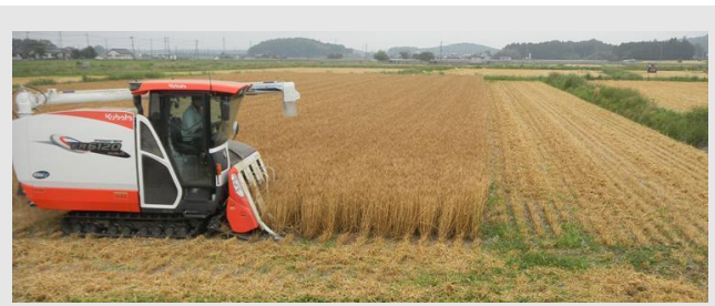
図1-7 収量・食味コンバイン(クボタ・ER6120)による小麦の収穫作業
