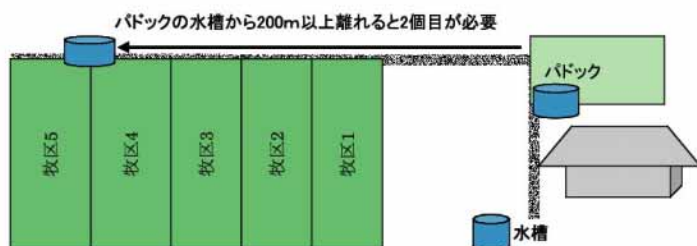
図Ⅲ－32 パドックと通路に設置した場合の水槽の設置例
