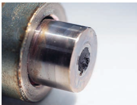
写真2 1600時間使用ノズル
