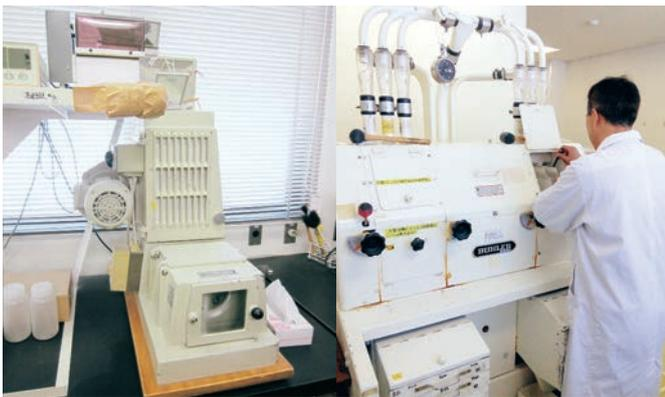
写真/東北農研でコムギの品種開発に利用している試験用製粉機
