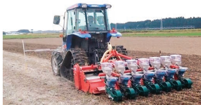
写真1／チゼル有芯部分耕による播種作業
