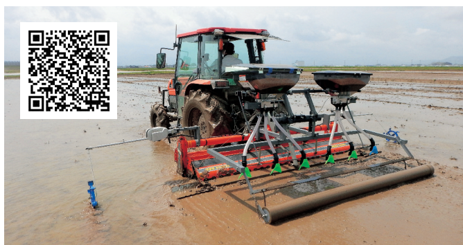
写真1 / 代かき同時浅層土中播種機 QRコードで代かき同時浅層土中播種栽培の動画が見られます。
