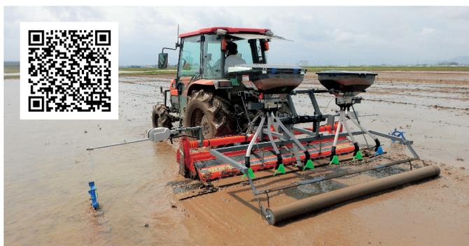
写真1 / 代かき同時浅層土中播種機
