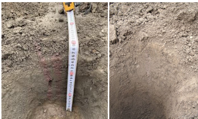
図4 ジピリジル溶液噴霧後の土壤断面（還元処理終了後） ハウス中央部（左）は赤い着色が確認されるが、周縁部（右）は着色がほとんど見られない。
