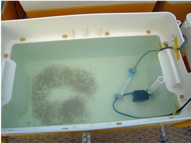
写真 2-9 循環ポンプとオートヒーターをセットし、液肥約 30L を注入したホームハイポニカ Sarah の液肥槽
