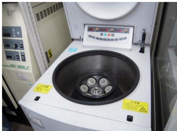
写真2-29 250mL用固定角ローターに遠心瓶6個をセットした遠心分離機
