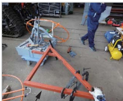
暗渠管リール台
