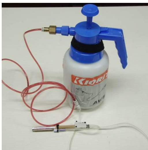
図3 試作した自動洗浄ナイフ
