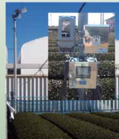
試験用気温差制御防霜ファン
