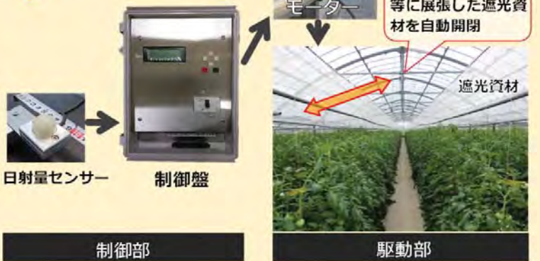
システムの構成 (左：実用化した制御盤)
