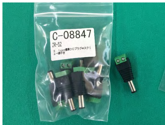
2.1mm 標準 DC プラグ⇔スクリュー端子台
